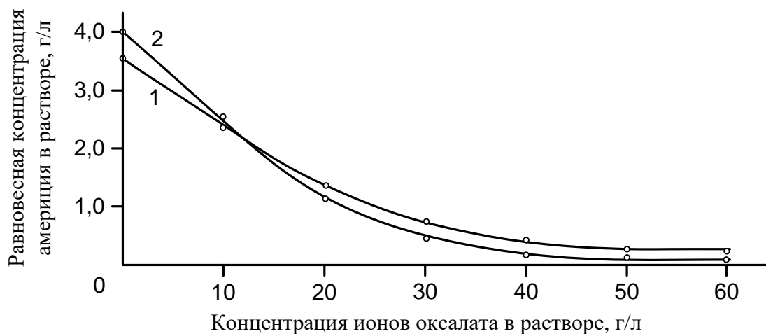
Рисунок 2.23 – Влияние избыточного сверх стехиометрии содержания ионов оксалата на концентрацию америция в маточном растворе при постоянном значении ионов кальция 5,0 \text{ г/дм}^3 (1 – для раствора состава 1, 2 – для раствора состава 2)
